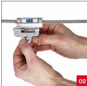
Coloque UniGrab de 8 mm en el cableado y ciérrelo moviendo la pestaña superior hacia abajo y hacia la derecha.
